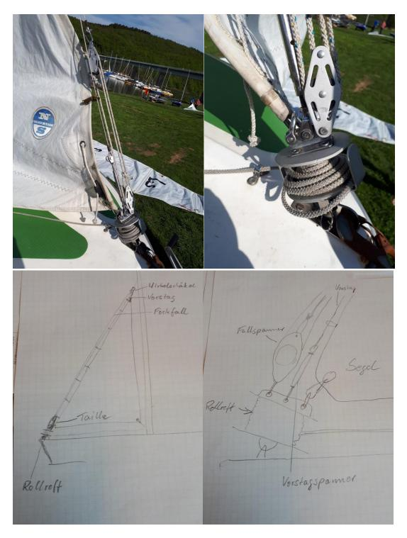
Vorsegelkonstruktion. Darauf achten das der Wirbelschäkel am Mast oben ungehindert drehen kann, sonst geht das Segel nicht gut auf.
